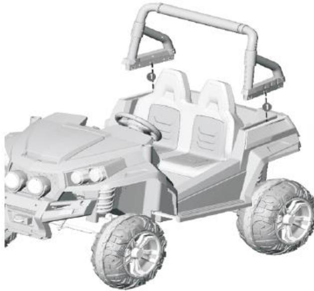
1. Insérer l'arceau arrière dans la glissière prévue à cet effet et le presser fermement jusqu'à ce qu'il soit fixé.
