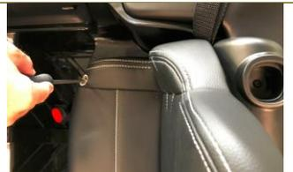
Dernière opération, **l'installation de l'arceau de sécurité**. Le positionner et l'enfoncer dans les trous jusqu'au « click » de mise en place.
