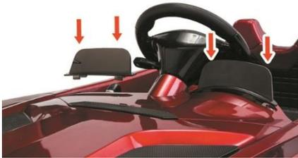
Les parebrises se fixe sur l'avant du véhicule. Aligner les parebrises, sur les espaces prévus pour les accueillir, et les glisser dans la fente jusqu'à entendre le « click » de fixation.
